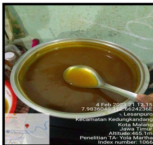
Gambar 22. Proses dekantasi larutan fitobiotik (3-4 jam)
