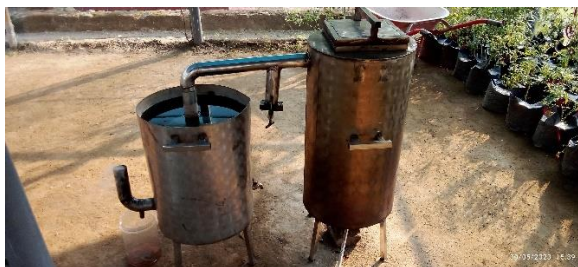
Gambar 2. 2 Proses Pembuatan Asap Cair
